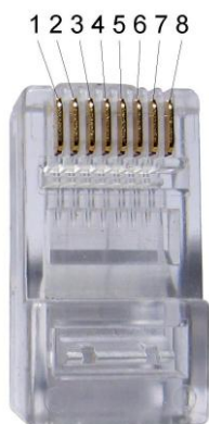
Numerotarea pinilor la conectorul RJ-45
